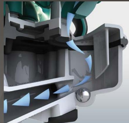
Die automatische Vakuumschaltung aktiviert das volle Vakuum jedes einzelnen Viertels erst dann, wenn der Melkbecher von der Zitze verschlossen wird. Das Vakuum bleibt stabil, denn Luftschlüpfen und daraus resultierende Verschmutzungen des Milchweges sind beim IQ Melkzeug nahezu ausgeschlossen. Ihre Milch bleibt einfach sicher sauber.
